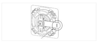
Wenn das Elektronikschloss in der Europäischen Wirtschaftsgemeinschaft (EU und EFTA) installiert wird, muss das beiliegende Typenschild gut sichtbar, lesbar und dauerhaft auf dem Riegel (auf der Rückseite der Tür) angebracht werden. Andernfalls entspricht das Produkt nicht dem Sicherheitsstandard der RED (Radio Equipment Directive).
