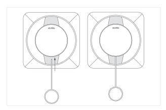
Öffnungs-Pin in der Position halten und den Pin mit dem Mantel (in der Skizze als grau hinterlegte Fläche dargestellt) um ca.10° gegen den Uhrzeigersinn drehen. Das Bedienfeld wird bei diesem Vorgang nicht gedreht.
