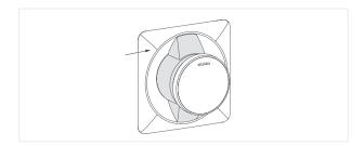
2 Öffnungs-Pin vorsichtig bis zum Widerstand in die Öffnung unterhalb der Bedieneinheit stecken und <u>leicht</u> drücken.
